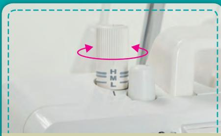
**Nähfußdruck:** Der Fußchendruck kann entsprechend dem Material angepasst werden, was für ein noch besseres Nähergebnis sorgt.
