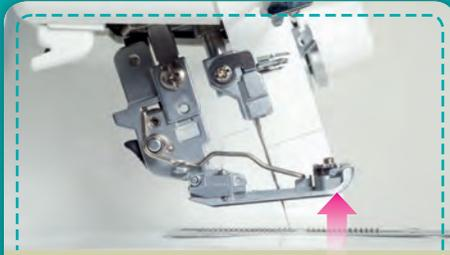
**Nähfußlüfter:** Der 2-stufige Nähfußlüfter bis 10 mm erleichtert das Nähen von mehreren Stofflagen.
