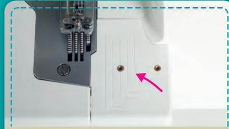
**Stoffführung:** Die Linien des Covertisches helfen den Stoff noch exakter beim Nähvorgang zu führen.
