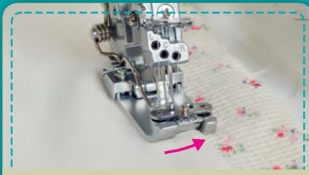
**Standardfuß mit Ausgleichsführung:** Durch die Ausgleichsführung werden verschiedene Stofflagen besser erfasst und geführt - ein noch besseres Nähergebnis kann erzielt werden.
