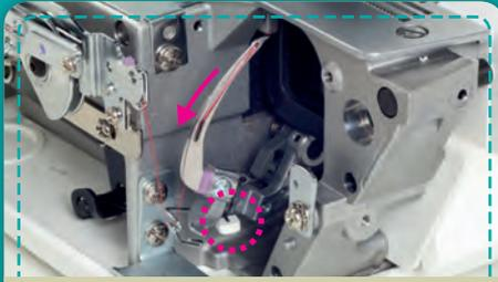
**Greifereinfädelhilfe:** Leicht und schnell den Greifer einfädeln. Folgen Sie einfach den Einfädelpunkten.
